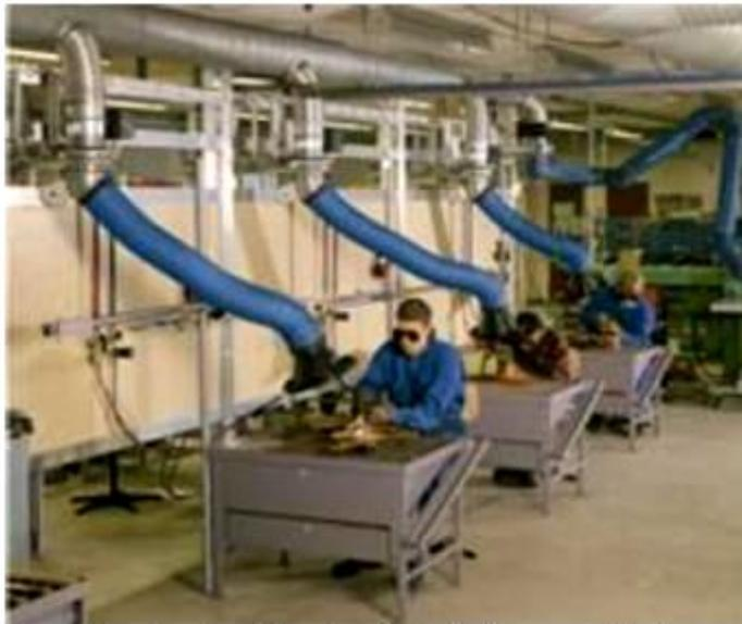
**Fig. 4** – Ambiente de trabalho ventilado e com sistema de exaustão.
