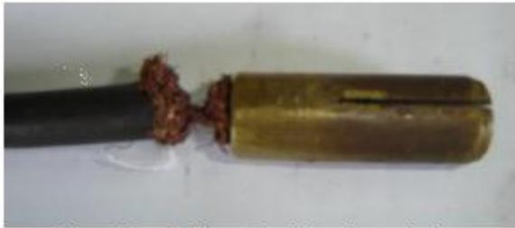
**Fig. 38** – Cabo danificado próximo Ao conector
